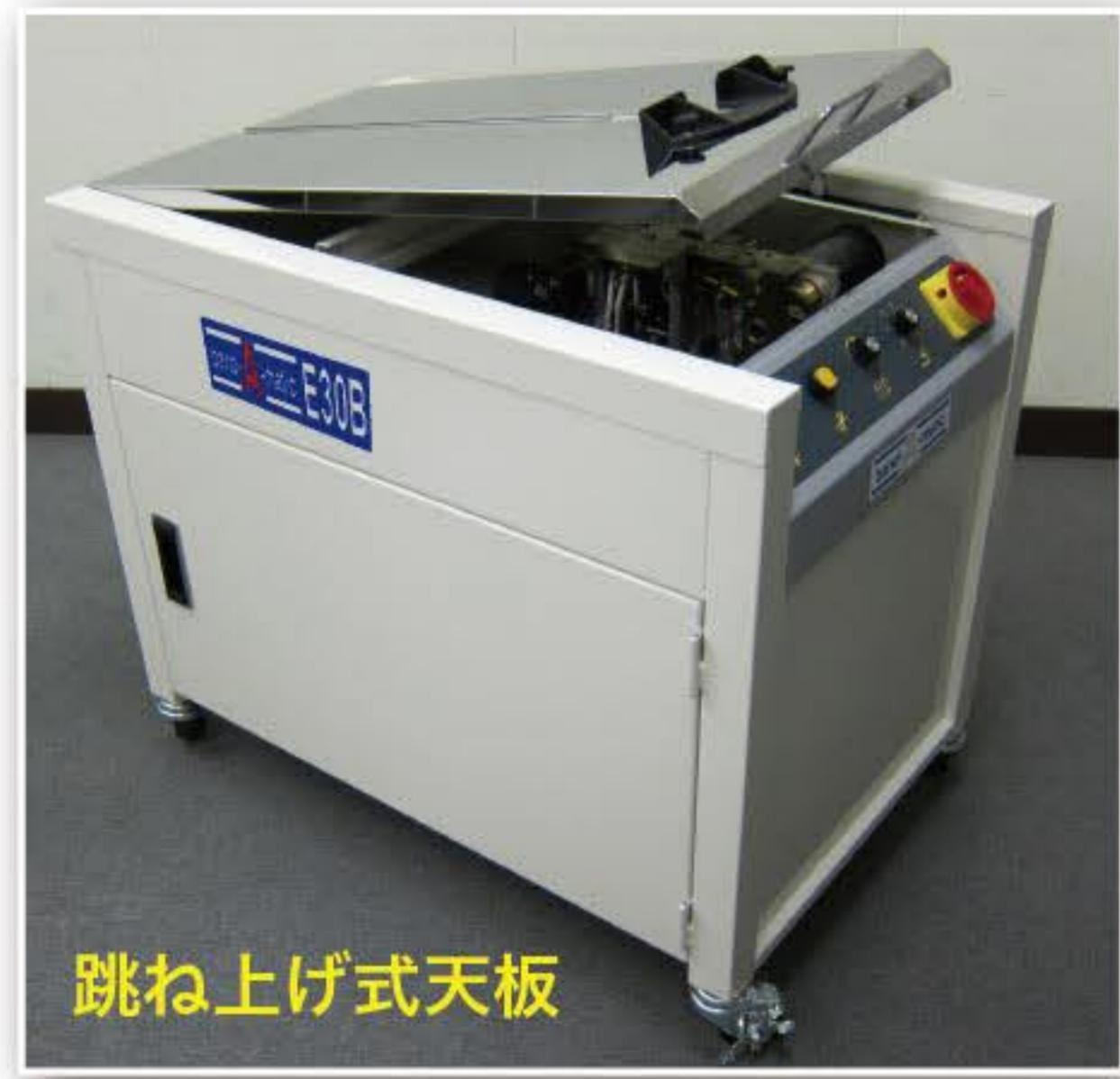
トラブル発生時や定期メンテナンス時に、意外に面倒な天板を取り外すという作業から解放するのが今回採用した跳ね上げ式天板。E30シリーズの特徴的デザインの一つです。
